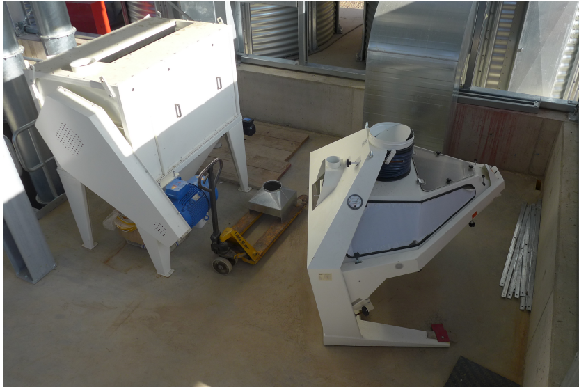
Bild 4: Bürstenmaschine (links), Steinausleser (rechts), Rupp Landhandel GmbH, Foto: Thorsten Neubauer
